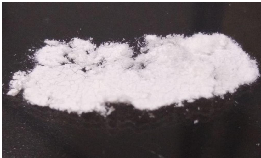
Imagem 1 – Fibras de aerogel obtidas por meio de sílica micrométrica.
